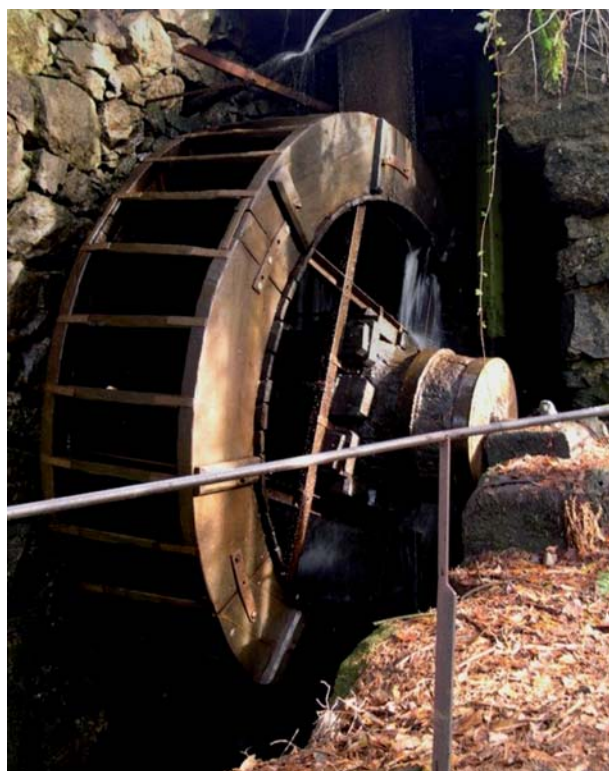
Rueda hidráulica del Martinete (de tipo vertical).
