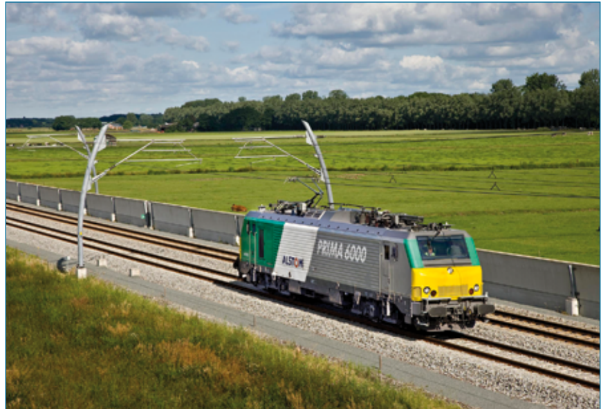
© Alstom. Locomotora Prima equipada con el sistema ATO en el trayecto que une el Puerto de Rotterdam con el Centro Logístico de Intercambio de Contenedores (CUP) de Valburg, en la parte oriental de los Países Bajos. La locomotora, suministrada por la compañía ferroviaria RRF, recorrerá cerca de 100 km sin la intervención del conductor, en las secciones ferroviarias equipadas con sistemas ERTMS (1 y 2), instalados por Alstom.
