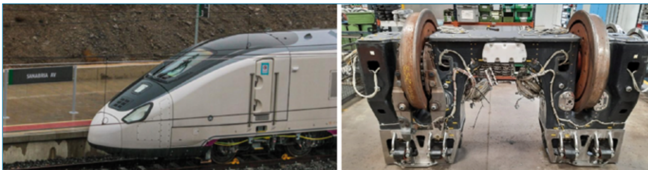
Frontal del AVRIL en CFRP y prototipo del rodal ligero.
