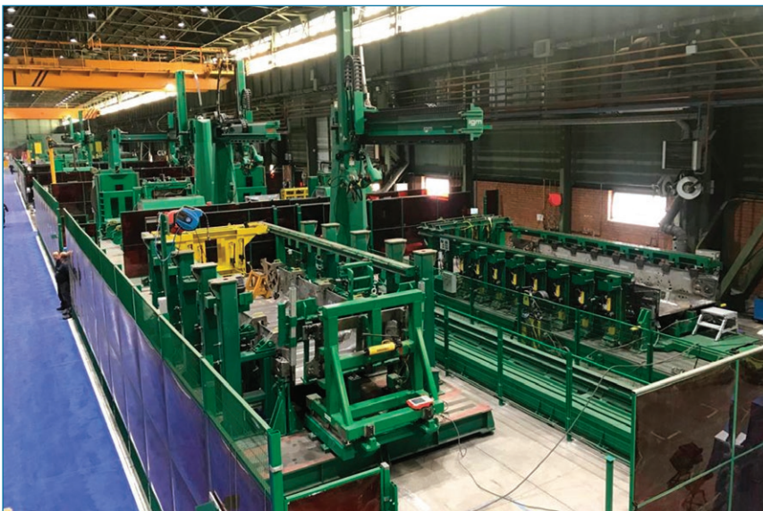
Vista parcial de la línea de soldadura robotizada de barcas blindadas.
